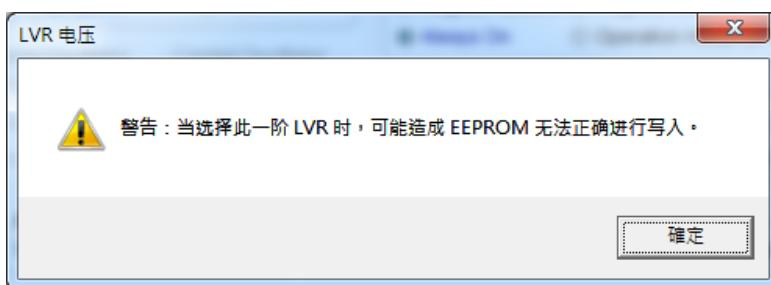
EEPROM 建议的最低工作电压为 2.4V，因为 LVR 选择低于 2.4V 可能造成 EEPROM 无法正确进行写入。若未使用到 EEPROM 功能，则可忽略此警告，选择更低的 LVR 电压。
